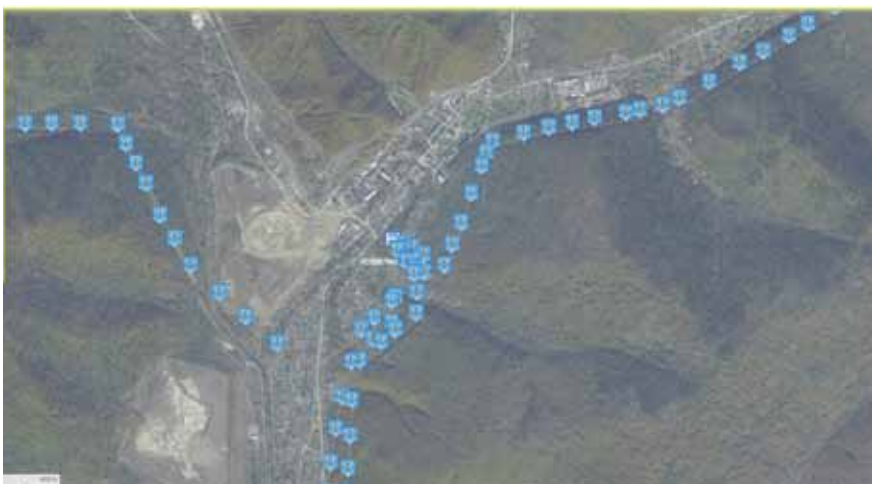
◀ Обозначение трассы ЛЭП в ГИС
