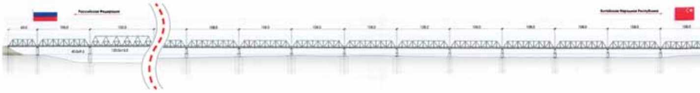
2209,5 МЕТРА СОСТАВИТ ДЛИНА МОСТА, ИЗ НИХ 309 МЕТРОВ БУДЕТ НАХОДИТЬСЯ НА ТЕРРИТОРИИ РФ И 1901 МЕТР – НА ТЕРРИТОРИИ КНР
