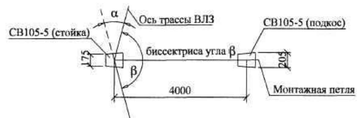
Схема установки стойки и подкоса
