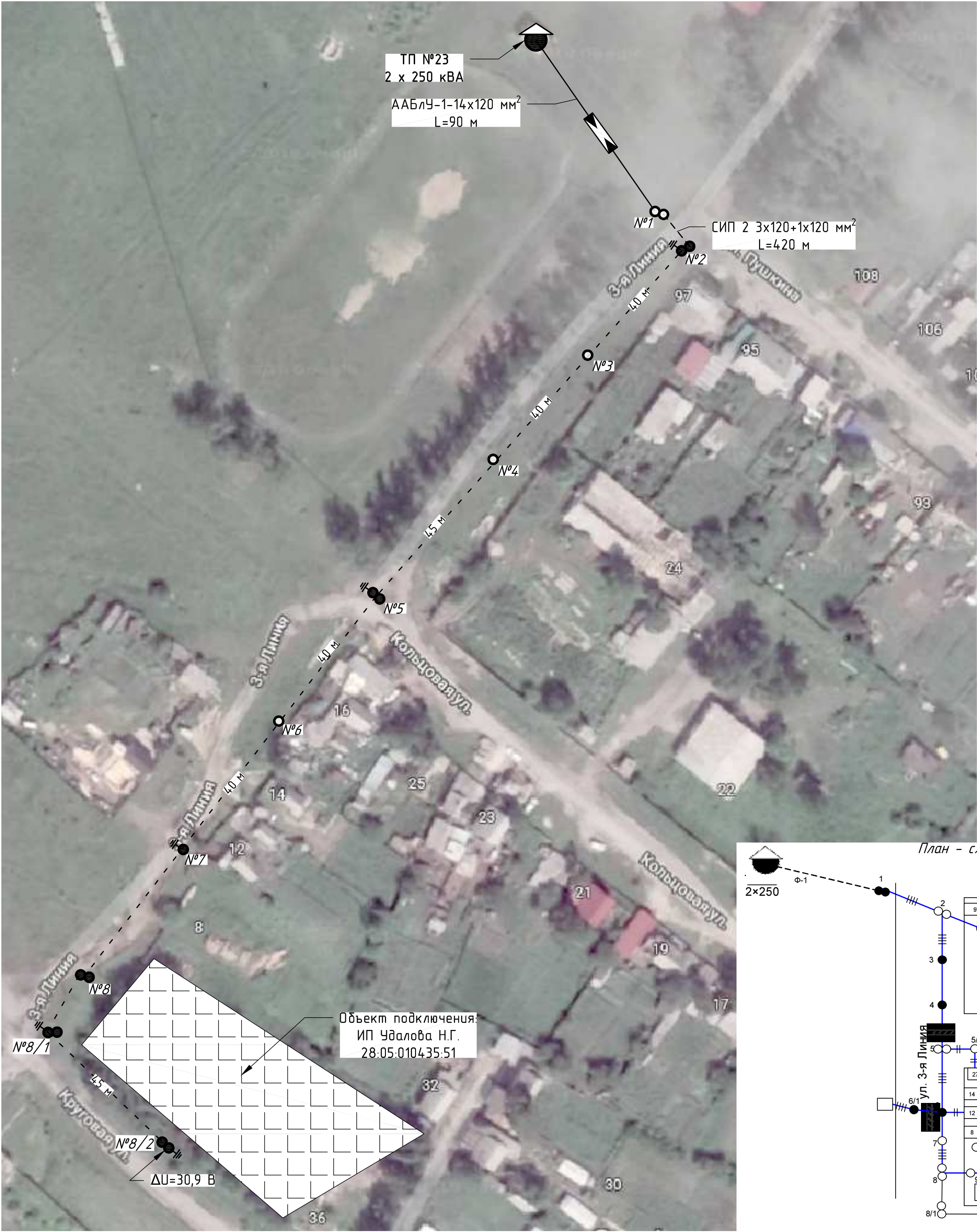
Схема заземления опор ВЛ-0,4 кВ
