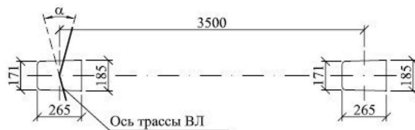
Схема установки стойки СВ95-3 (СВ95-2с, СВ95-3с)
